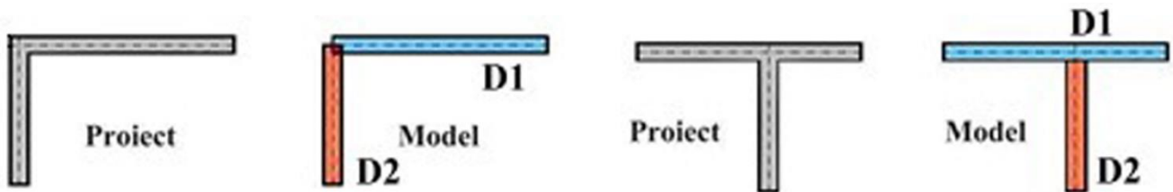
Fig. VII.9. Modelarea intersecțiilor de pereți pentru calcul.
